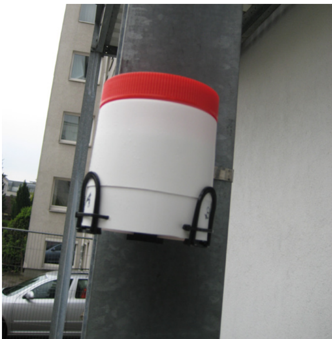
Abb. 42: Passivsammler zur Überwachung der Luft
